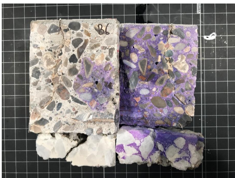
Figur 8-15: Borekerne B6 efter gennemskæring med indersiden mod opad. Den højre kernehelvdel er påsprøjtet pH-indikatoren Thymolphthalein.
