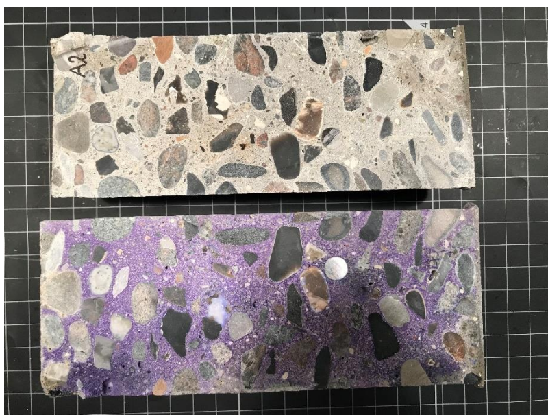
Figur 8-2: Borekerne A2 efter gennemskæring med overfladen mod venstre. Den nedre kernehaldel er påsprøjtet pH-indikatoren Thymolphthalein.
