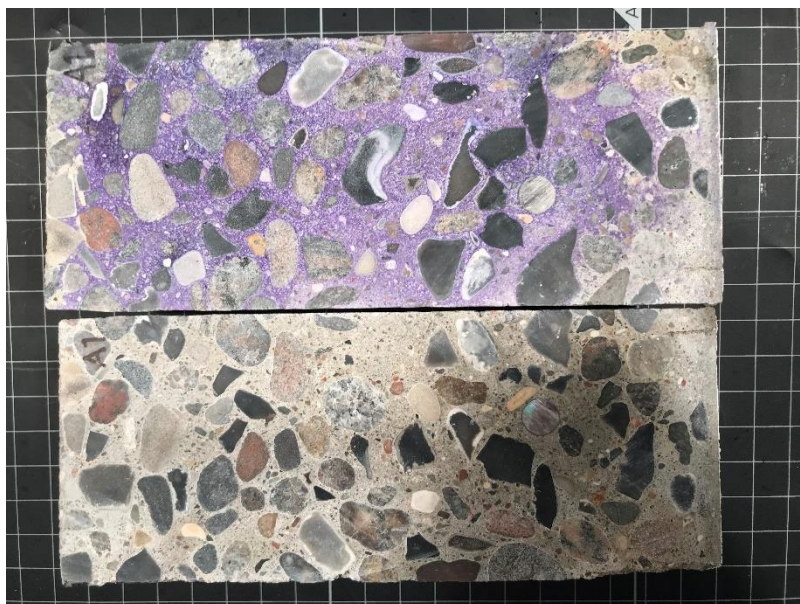
Figur 8-1: Borekerne A1 efter gennemskæring med overfladen mod venstre. Den øvre kernehaldel er påsprøjtet pH-indikatoren Thymolphthalein.
